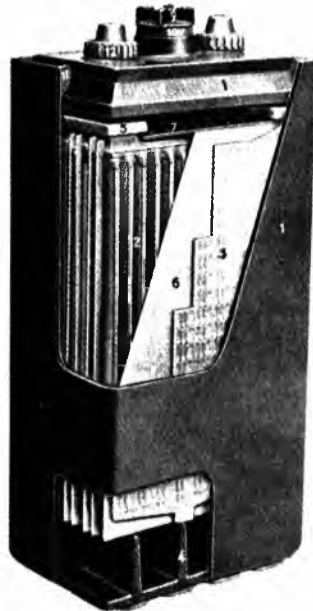
Sl. 5. Akumulatorski članak sa pozitivnim oklopnim pločama. 1 posuda od plastične mase, 2 pozitivna grupa ploča, 3 negativna ploča, 4 prizme od tvrde gume, 5 polni most, 6 izolator, 7 limeni pokrov, 8 zaliveni poklopac članka, 9 čep, 10 brtvilo, 11 masa za zalijevanje. 12 polna matica
