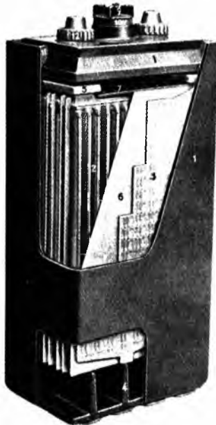
Sl. 5. Akumulatorski članak sa pozitivnim oklopljenim pločama. 1 posuda od plastične mase, 2 pozitivna grupa ploča, 3 negativna ploča, 4 prizme od tvrde gume, 5 polni most, 6 izolator, 7 limeni pokrov, 8 zaliveni poklopac članka, 9 čep, 10 brtvilo, 11 masa za zalijevanje, 12 polna matica
